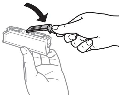
9. Inserte el cartucho de tinta diagonalmente en el soporte y empújelo con suavidad hasta que encaje en su sitio.
