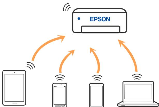
La impresora puede conectarse por Wi-Fi o por Ethernet, y por conexión Wi-Fi Direct (AP Simple) simultáneamente. No obstante, si inicia una conexión de red mediante Wi-Fi Direct (AP Simple) cuando la impresora está conectada por Wi-Fi, la red Wi-Fi se desconectará temporalmente.
