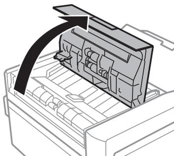
2. Use un paño seco, limpio y suave para limpiar el rodillo y el interior del ADD. Después, cierre la cubierta del ADD.
