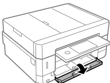
4. Compruebe que la impresora no esté en funcionamiento y luego extraiga la cassette de papel 1. La Cassette de papel 1 tiene una marca de alineación ► que permite localizarla rápidamente.
